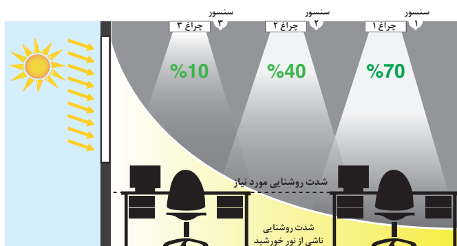
تنظیم شدت روشنایی چراغ ها با سنسور نوری 1-10V DC
